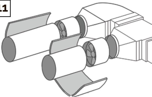
**В приточный и вытяжной каналы проденьте воздуховоды-удлинители.** Для плотного соединения стыков вентиляторов и вент. каналов можно использовать изоляционную ленту. Перед этим воздуховоды необходимо обернуть несколькими слоями фольгированного пенофола (фольгоизолон), либо, при отсутствии пенофола, утеплить с помощью любого другого теплоизоляционного материала.
