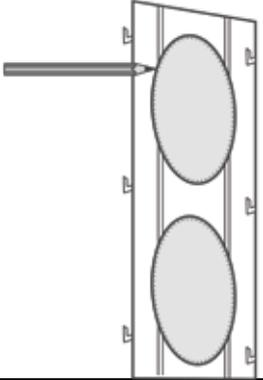
**4** На стене разметить место для сквозных каналов с помощью задней стенки корпуса, воспользовавшись ей как лекалом.
