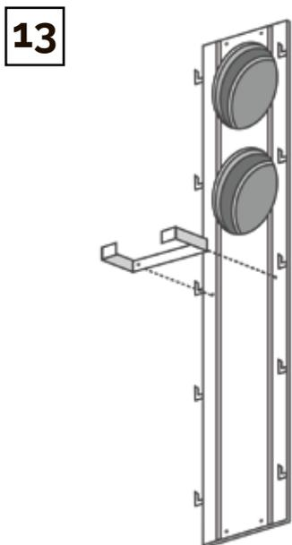
Закрепите заднюю стенку корпуса рекуператора на стене с помощью крепежа предназначенного для того типа стен, на который монтируется рекуператор.
