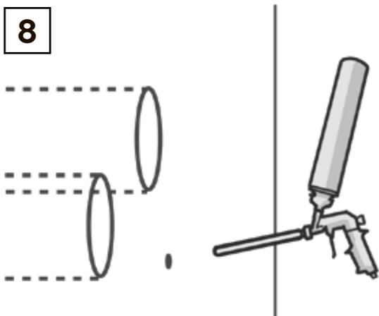
**После использования бурильной установки** нужно запенить отверстие, в котором устанавливалась станина.
