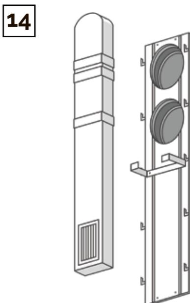
Поместить рекуператор на стене в держатель, размещенный на корпусе, одновременно с этим соединив рекуператор с воздуховодами, проходящими сквозь стену, и зафиксировать держатель.
