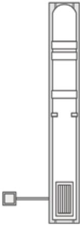
**Подключить вентиляторы и нагреватель** (в моделях с нагревателем) к сети 220 В через выключатель, регулятор оборотов и/или Wi-Fi контроллер, параллельным соединением согласно схеме подключения в инструкции
