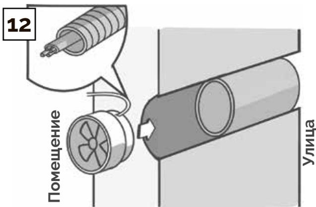
Электрокабель рекуператора уложите в гофру. В канал, предназначенный для вытяжки, проложите электрический кабель, подготовленный для подключения вытяжного вентилятора.
