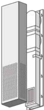
**Закрепить внешнюю крышку корпуса рекуператора на задней стенке.**
