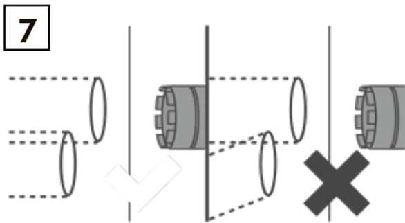
**Станину необходимо устанавливать ровно,** чтобы отверстия для воздушных каналов проходили параллельно.
